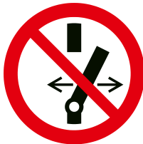
Verboden te schakelen
