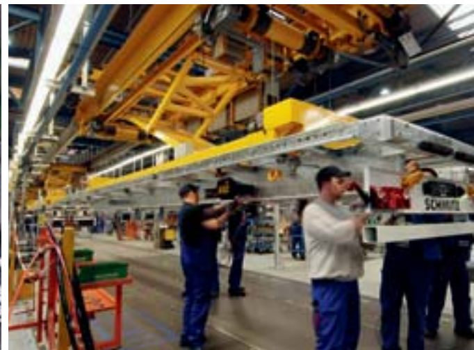
De serieproductie van Schmitz Cargobull is gebaseerd op een modulaire platformstrategie. Daardoor kunnen verschillende types op dezelfde assemblagelijnen worden gebouwd.
